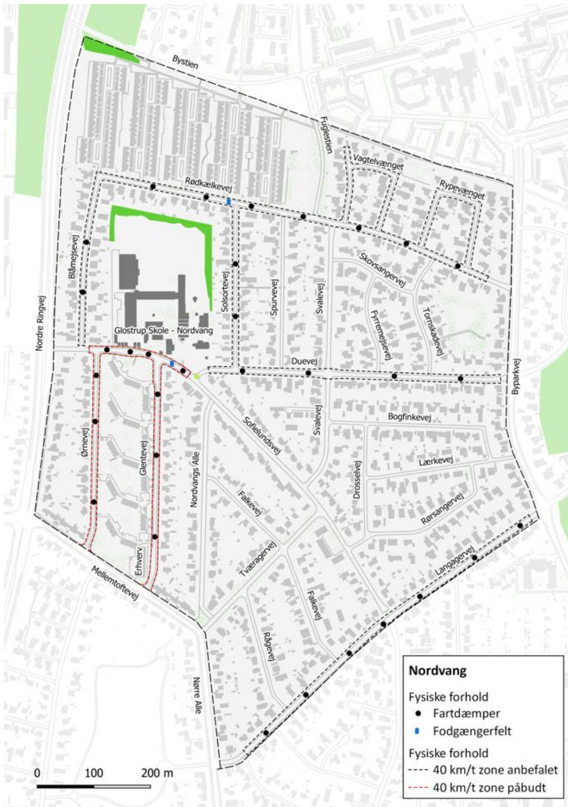
Figur 1. Trafiksaneringsområde 8 - Nordvang. Eksisterende forhold.
